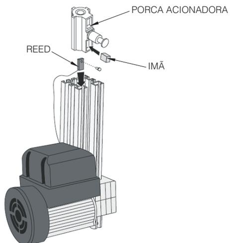
**2º Passo:** Coloque a borracha de proteção dos fios no alojamento do reed, percorrendo todo o perfil do trilho.
