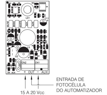
**Obs:** Podem ser ligadas mais de uma fotocélula ao automatizador, de forma cascata. Nessa configuração, ligue a saída OUT da segunda fotocélula à saída AUX da primeira, e a saída OUT da primeira deve ser ligada à entrada de fotocélula do automatizador.
