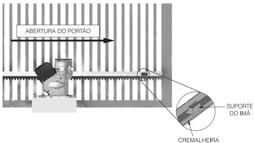
**3º Passo:** Acione o motor e observe se os REED's estão desligando corretamente. Caso haja necessidade, inverta o conector da placa. Depois de fixados os suportes dos imãs, faça os ajustes finais, deslocando-os para a direita ou para a esquerda, conforme o ajuste desejado.
